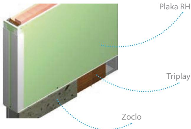
Como una buena solución para el diseño de interiores te sugerimos cortar la Plaka RH y colocar un zoclo de loseta a paño de la placa, logrando un muro perfectamente liso. No olvides sellar con sellador de poliuretano Tekbond en la unión de estos dos materiales. Recuerda, antes de colocar la loseta fija, instalar una hoja de triplay de 3mm entre el bastidor y la loseta.
